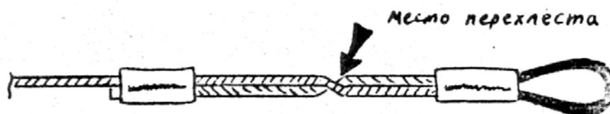
1.5.9. В качестве заделок необходимо использовать трубки из пластичных материалов (меди и её сплавов, латуни, нержавеющей стали) с внутренним диаметром равным:
